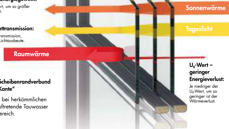
Wärmeschutzglas z.B. U_g = 0,6 \text{ W/m}^2\text{K}
